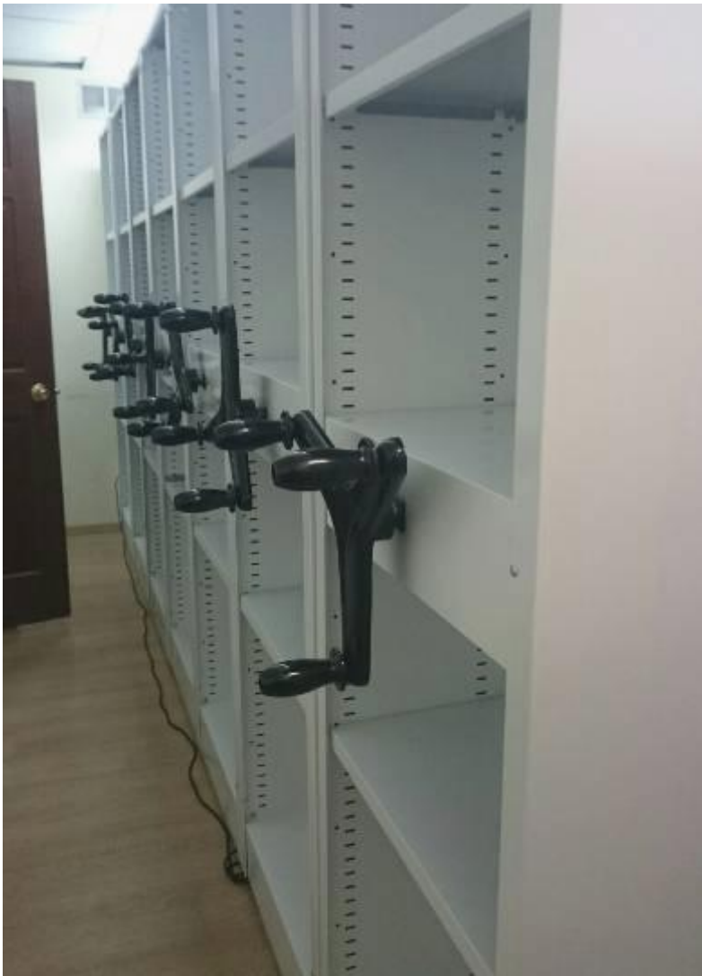
Фото 7. Стеллажи с трехсторонней загрузкой. Кроме боковых секций используется фронтальная секция; на ней удобно хранить документы, с которыми идёт текущая работа (документы под конкретный проект, заказ, подборка документов при проверке надзорными органами и т.п.).
