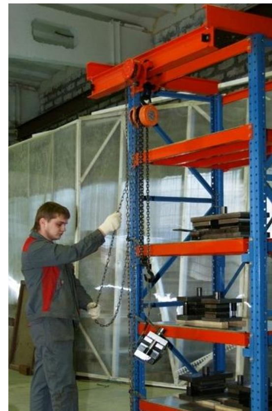
Стеллаж Slide со встроенной талью. Высота 2700 мм.
